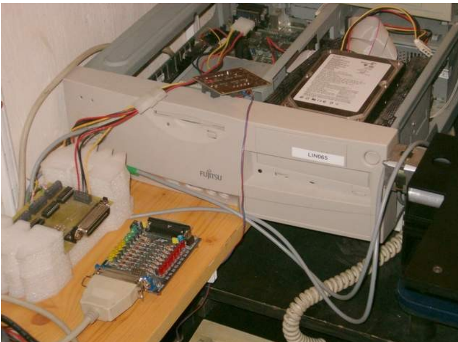
Rys 3.7 – Komputer sterujący używany do testów i płytka z mostkami mocy
