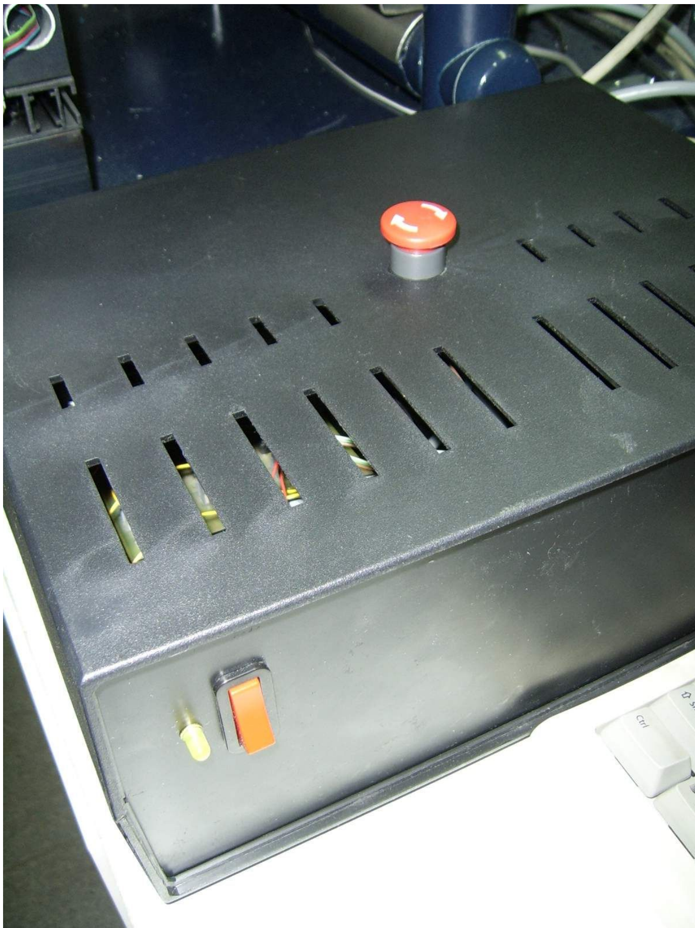
Fot. 3.4 – Obudowa układów sterujących, wyłącznika awaryjnego i włącznika zasilania przekaźnika WN
