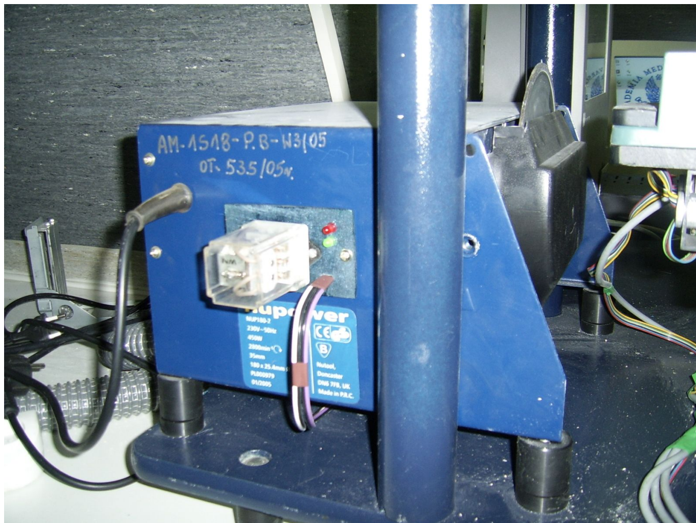
Fot. 3.3 – Przekaznik WN sterujący napędem szlifierki
